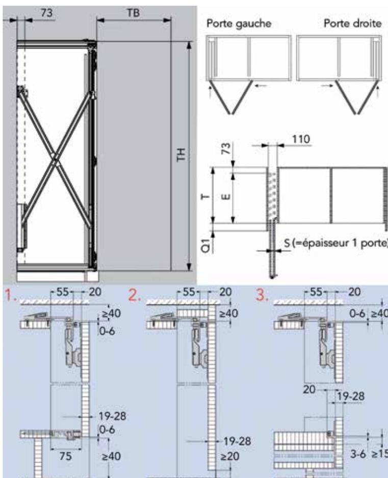
**Ferrure pour portes pliantes et rentrantes type Folding Concepta 25 pour une armoire avec 2 portes**
