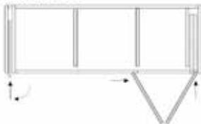
**Ferrure pour portes pliantes et rentrantes type Folding Concepta 25 pour une armoire avec 3 portes**
